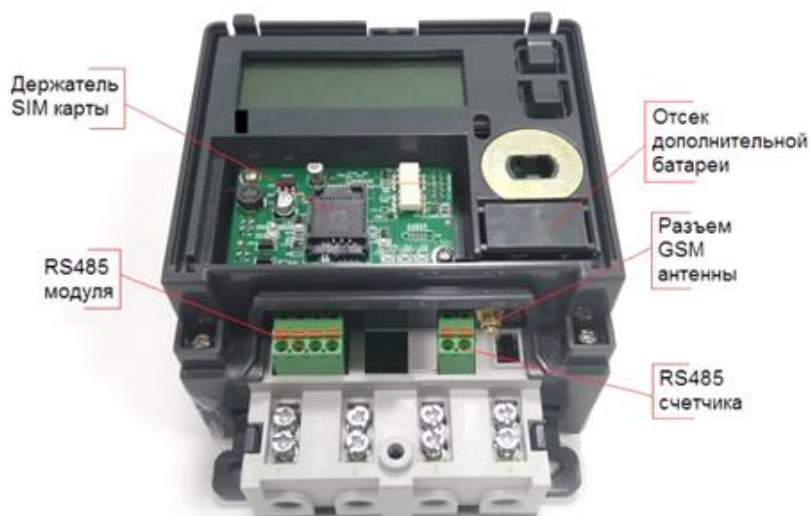
Рисунок 5.4 – Элементы подключения счетчика «Меркурий 204»
