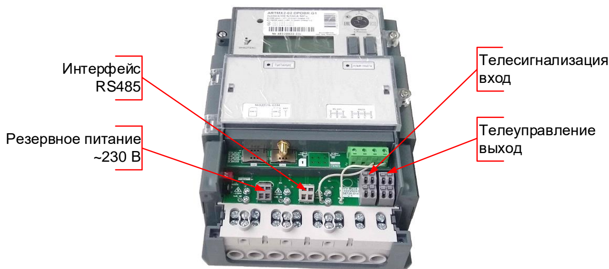
Рисунок 5.5 – Элементы подключения счетчика «Меркурий 234» с индексом «Х»
