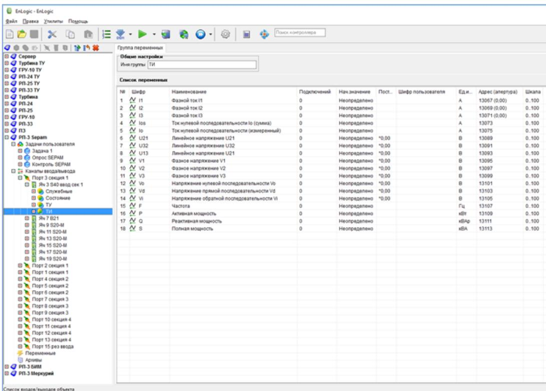
При конфигурировании узла ENLOGIC инженер оперирует понятными категориями и терминами – протокол обмена, модуль ввода-вывода.
