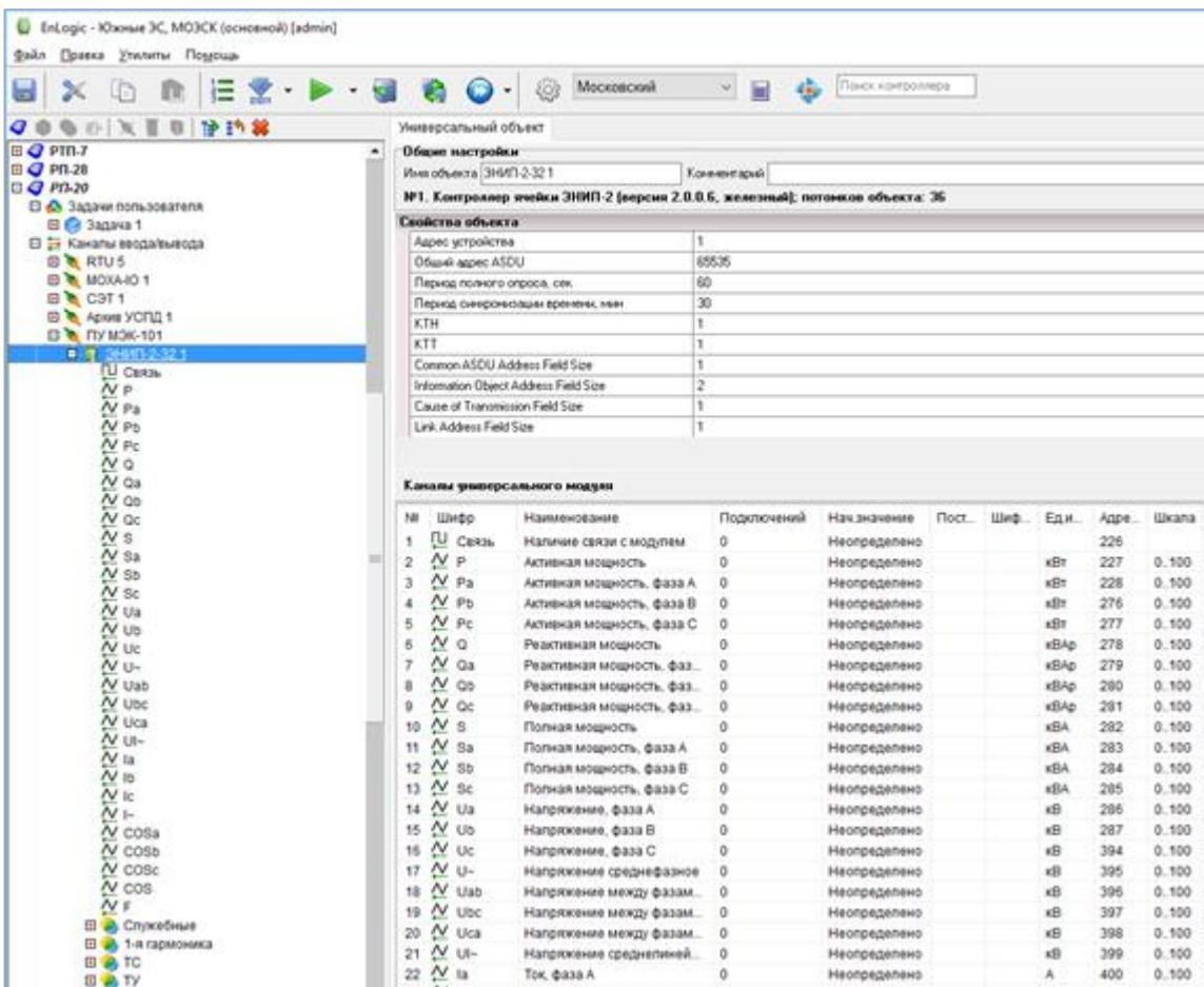
Удобное разделение элементов дерева конфигурации на группы-объекты и максимальная типизация в описании устройств различных производителей далее позволяет максимально эффективно осуществлять настройку программного обеспечения верхнего уровня SCADA ЭНТЕК. При этом также сохраняется возможность гибкой настройки выходной карты переменных МЭК-104 узла ENLOGIC, которую при необходимости можно привести к виду, требуемому заказчиком.
