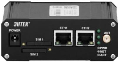
Контроллер КМ ЭНТЕК E2R2-(G)-1 имеет коммуникационные порты связи RS-232, RS-485, Ethernet с поддержкой протоколов обмена данными в соответствии с МЭК870-5-101, МЭК870-5-104, ModBus.
